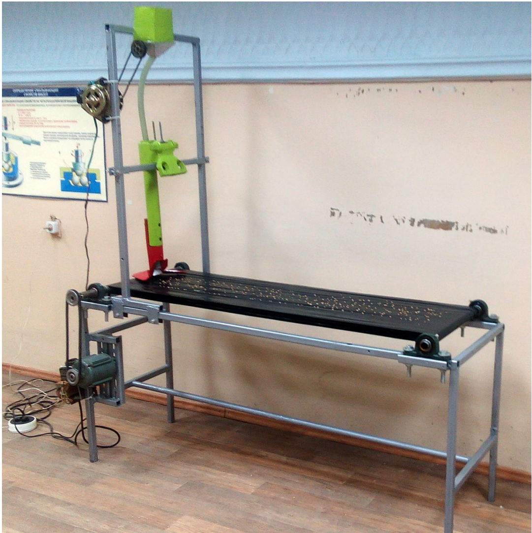
Рисунок 3.4 – Общий вид лабораторной установки для оценки ширины и равномерности распределения посевного материала
