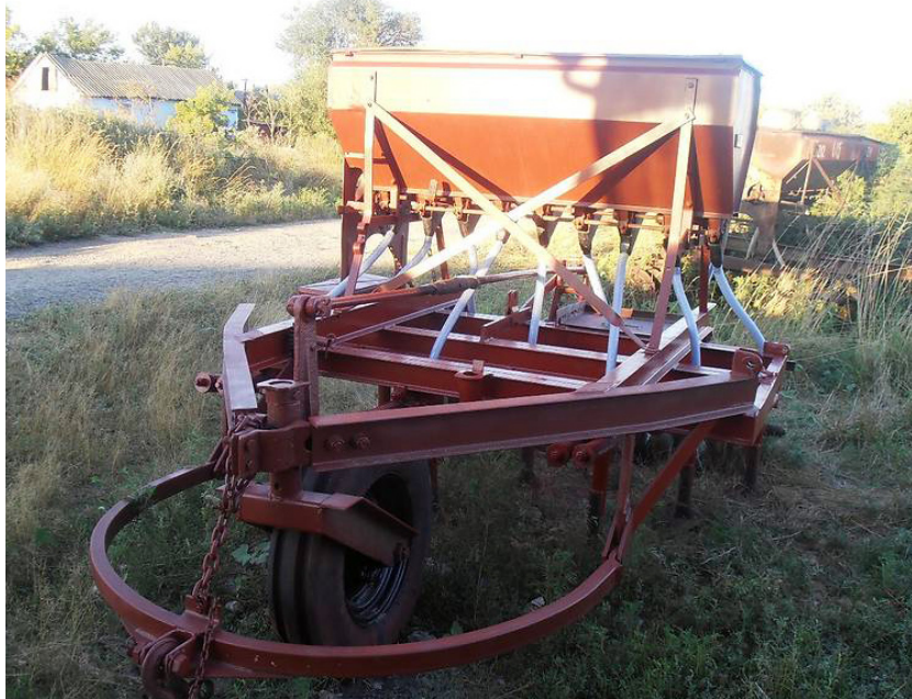
Рисунок 4.2 – Сеялка, оборудованная экспериментальными сошниками
